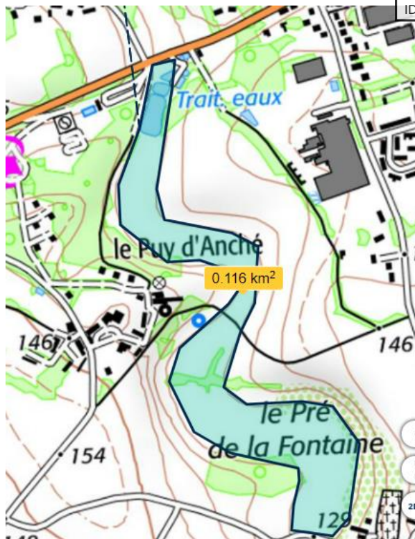
Zone d'expansion de crue en aval de la station d'épuration de Sauzé-Vaussais
